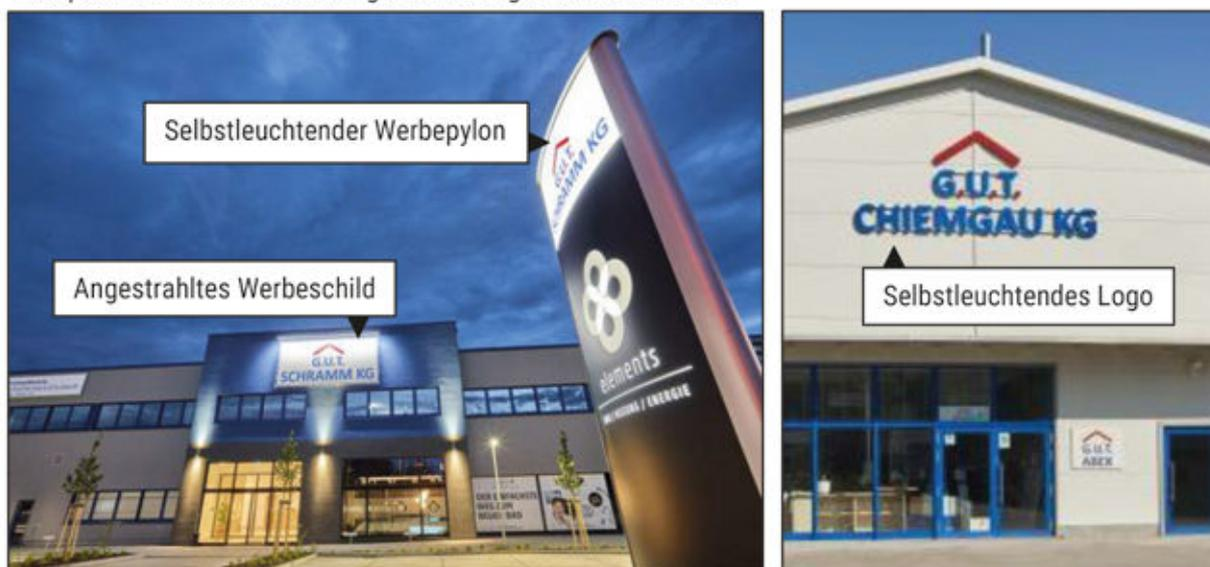
**Praxistipp:** Eine zuverlässige (jahreszeitenunabhängige) Abschaltung der Beleuchtung gelingt am besten mit einer Kombination aus Dämmerungsschalter und Zeitschalter.
